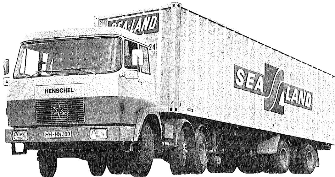
**Diesel-Motor · 6 Zylinder · 4-Takt · 230 PS bei 2150 U/min**
